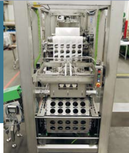
Abtransport der Becher mit Blick auf die Becherwendestation. Transportation of the cups with a view of the cup turning station.
