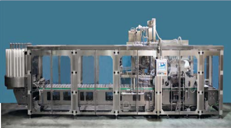
DOSOMAT 20.10, Inline-Ausführung. Hier noch ohne Verknüpfung zur Prozessanlage. DOSOMAT 20.10, Inline configuration, shown here before it is connected to the processing system.
