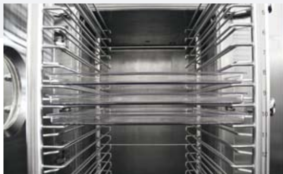
Innenansicht des Vakuumwärmeschanks mit Hordenwagen. View of the interior of the vacuum heating cabinet with rack carriage.
