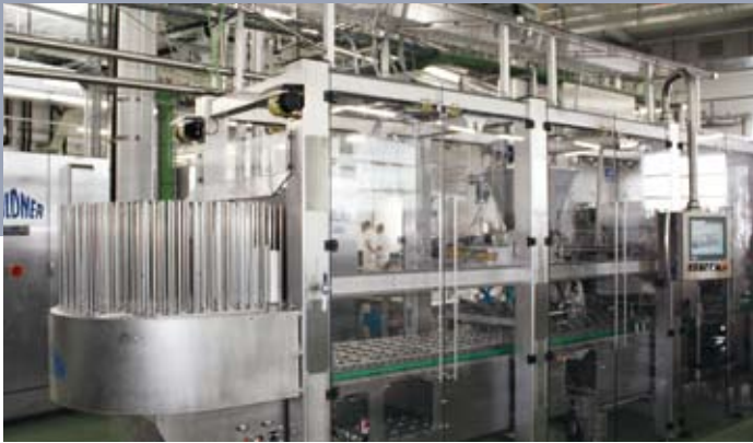
Ansicht Bedienerseite mit Becherbevorratung. View from the operator's side of the cup feed.
